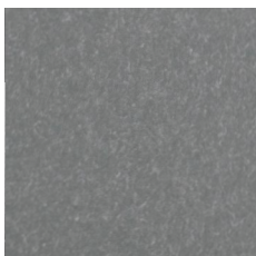
Faserzement - grossformatige Platten - dunkelgrau, matt - natürliche Struktur vom Faserzement sichtbar - Fassadenbekleidung, inkl. Dachaufbau (Technikzentrale)
