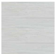
Sichtbeton - hellgrau - ruhige Oberfläche, Schalungstyp 4 - Gebäudesockel, Stützmauern - Annexbau Süd (Haupteingang) in Sichtbeton
